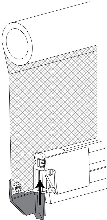
Enrouler la toile sur le tube d'enroulement en s'assurant qu'elle s'enroule symétriquement sur le tube.
