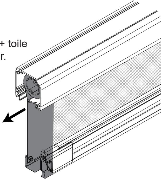
Dérouler la toile entièrement et la retirer du tube d'enroulement :
