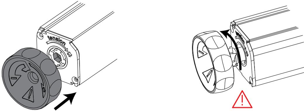
Retirer les vis des embouts de boîtiers.
