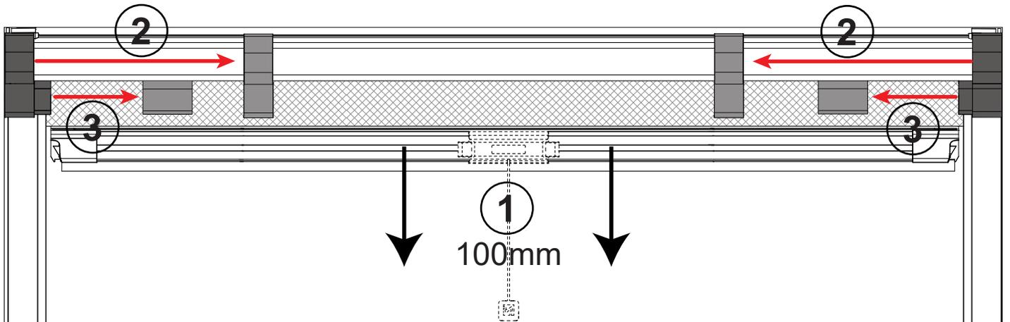
**ATTENTION : Pour les manoeuvres Chainette et 230V, retirer le slide côté mécanisme.**
