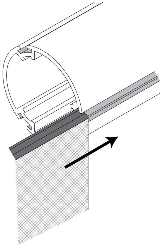
Dans le cas d'une toile spécifique (hors toile standard), appliquer un adhésif double-face fin sur le tube d'enroulement.
