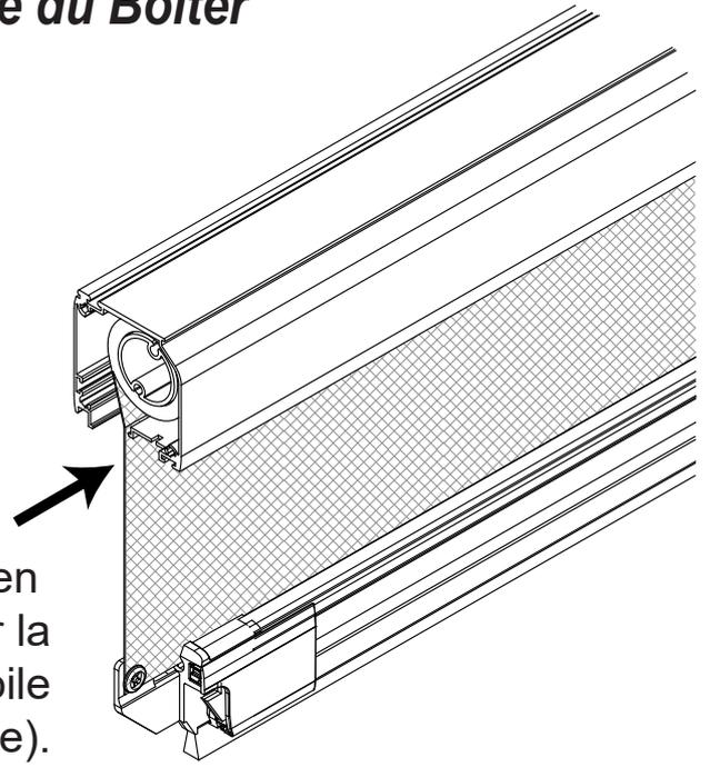
Insérer le tube + la toile + dans le boitier en s'assurant que la toile ne frotte pas sur la sortie de boitier (afin de ne pas abîmer la toile moustiquaire).
