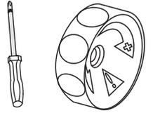
Détendre le ressort de tension (version à ressort uniquement).
